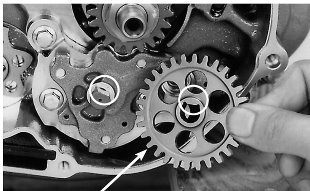
ENGRENAGEM MOVIDA DA BOMBA DE ÓLEO
